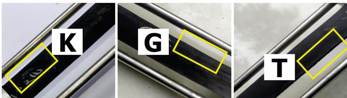
Gambar 5. Retak permukaan pada produk rubber spring
