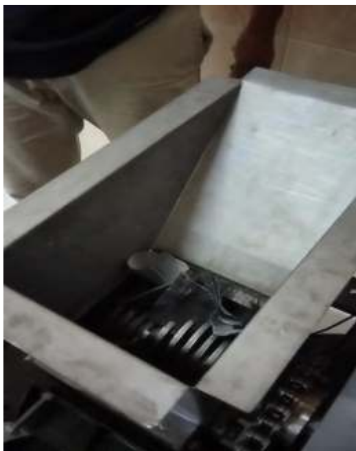
Gambar 2. Penggilingan limbah ban-dalam yang telah direndam dalam larutan kerosin pada waktu optimum menggunakan mesin giling
