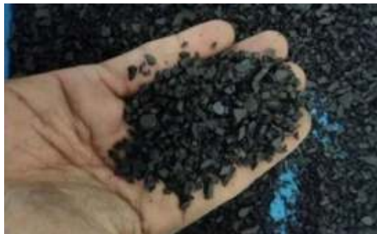
Gambar 5. Tampilan crumb rubber dari ban-dalam.
