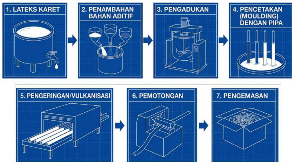
Gambar 1. Diagram alir skematik pengolahan karet gelang
